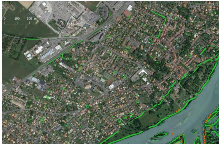
**Figure 70: Exemple d'artefacts sur la courbure liés aux bâtiments et route**
