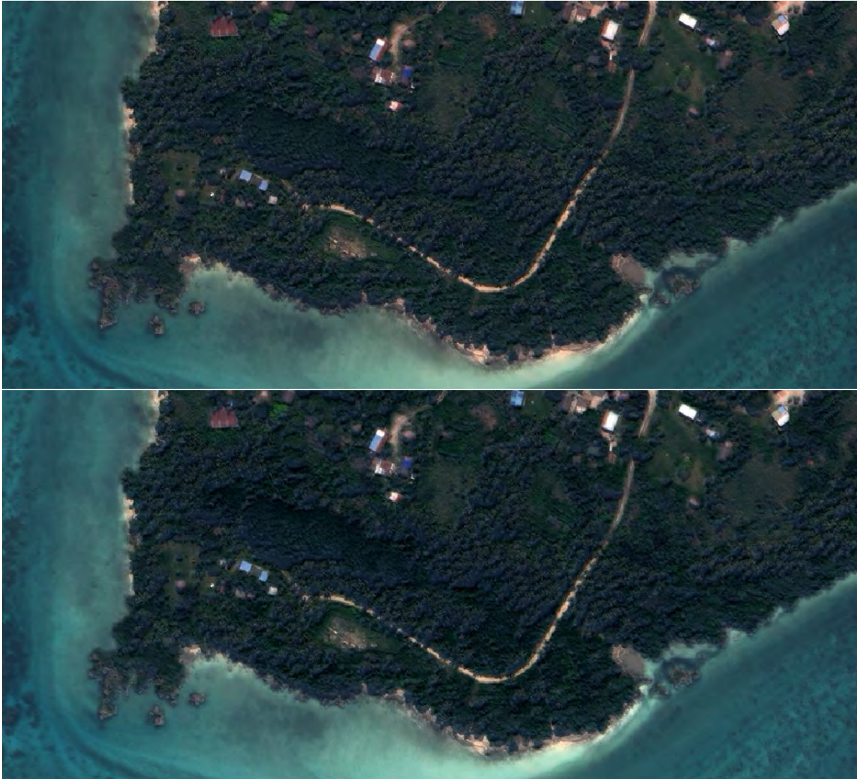
Figure 15: Au-dessus: mode de fusion Gram Schmidt sur les canaux 5, 3,2. Au-dessous: mode de fusion en Composante Principale sur les canaux 5, 3,2.
