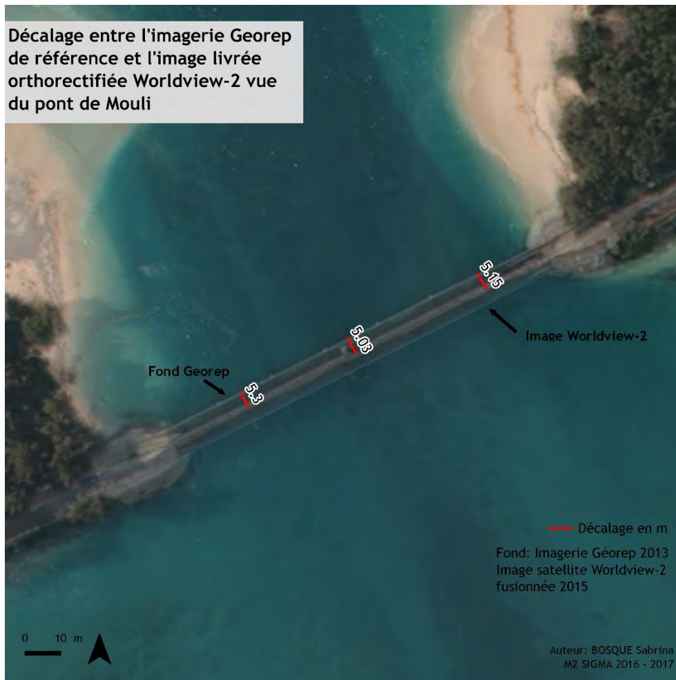
Figure 17: Superposition de l'image worldview2 livrée orthorectifiée à l'imagerie Georep de référence, (extrait sur pont de Mouli) et visualisation du décalage géométrique.
