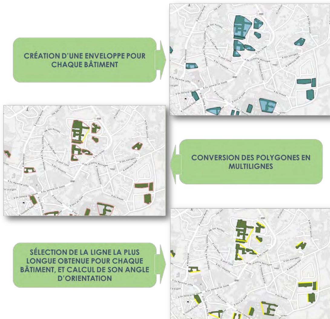
Figure 14 : Illustration des opérations géométriques réalisées par la fonction permettant de déterminer l'orientation des toitures des bâtiments (source : DDTM 2018)
