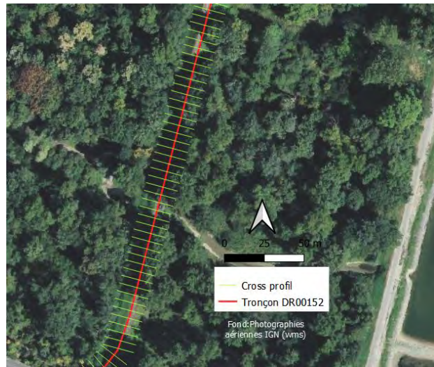
Figure 17: Création des profils en travers
